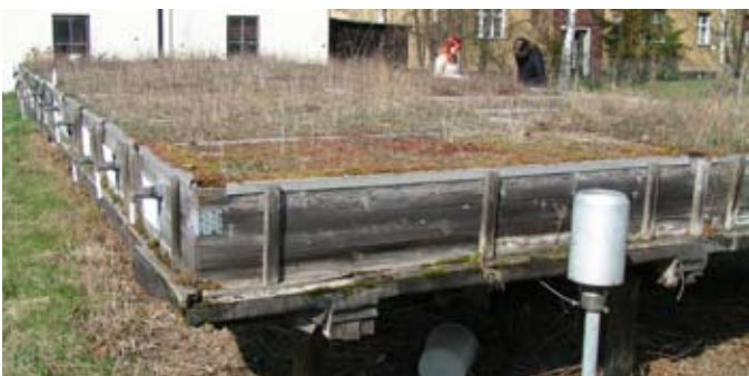
Messung von Verdunstung und Ablauf von extensiv begrünten Dachparzellen mit unterschiedlichem Aufbau (u. a. 5 und 12 cm Substrat, s. Abb. S. 12)
