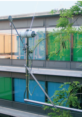
Messgeräte zur Bestimmung der potenziellen Verdunstung
